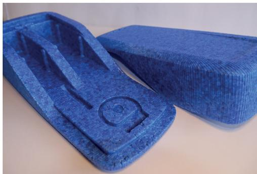
Die Dampfdüsen werden beim 3D-Druck zum Teil als Designelement ausgeführt, zum Teil in der Textur kaschiert. An der Seite des etuiartigen Musterteils sind sie als Linienstrukturen, auf der flachen Oberfläche als feine Punkte erkennbar
