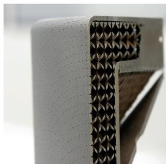
In der Kavitätenoberfläche werden beim Laserschmelzen mehrere Tausend schlitzz- und punktförmige Düsen mitgedruckt (links). Hinter der Werkzeugwand befindet sich die Gitterstruktur (rechts), die zugleich den Raum für die Dampfkammer und Kühlwasserführung bildet © Hofmann
